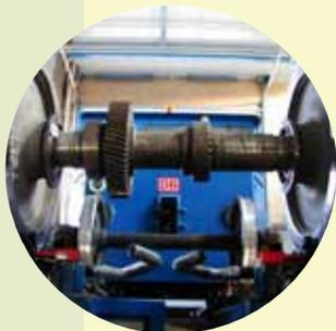
通过对轮对踏面数模和其他刹车盘的研究，OPTIMESS传感器可用来测量整个轮对的几何参数。
